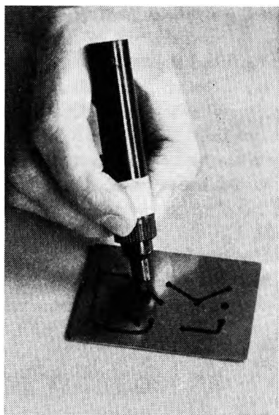
Tegning af ledningsførelsen med lynskriver på printplade
